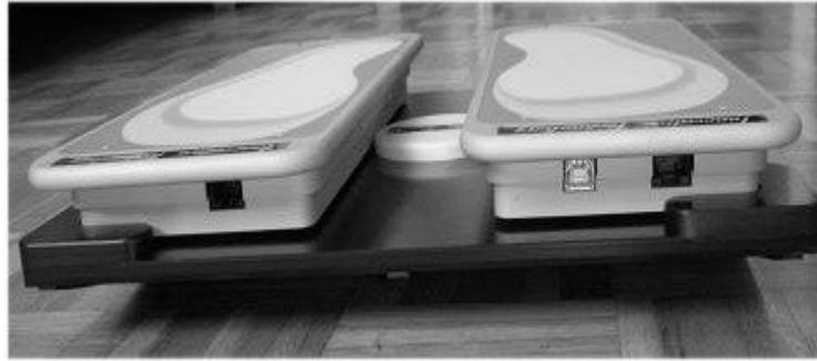
Fig. 1 Cyber sabots composés de 2 sabots dynamométriques sur plateforme de Bessou
